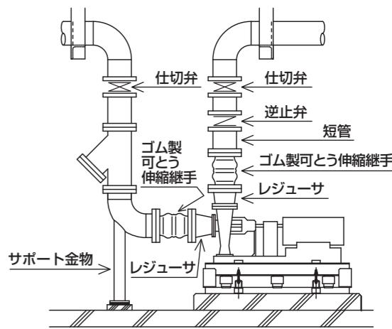
なお、ゴム製可とう伸縮継手は大口径や大変位用の場合、配管内圧により許容値以上の伸びが生じることがありますので、十分な強度の配管サポートを取付けてください。また、エキスパンションの用途として使用する場合は固定位置にご注意ください。
