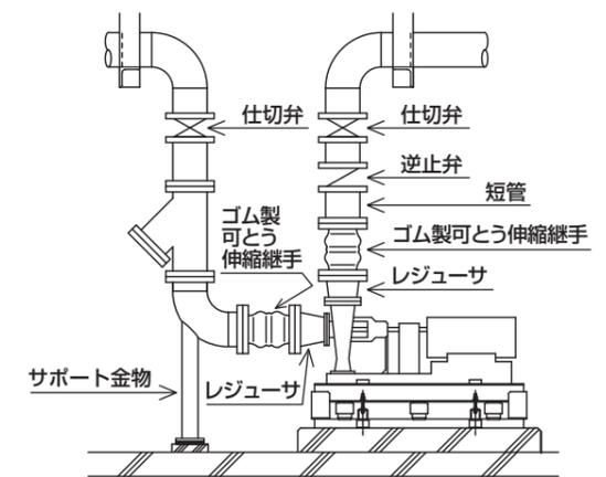
なお、ゴム製可とう伸縮継手は大口径や大変位用の場合、配管内圧により許容値以上の伸びが生じることがありますので、十分な強度の配管サポートを取付けてください。また、エキスパンションの用途として使用する場合は固定位置にご注意ください。
